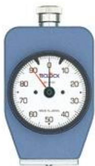
GS-743G Type E2 Durometer Soft rubber
