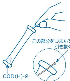
①チューブ先端のラインを引き抜きます。
